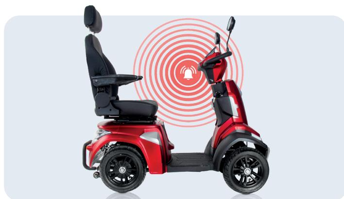
Lo scooter Madagascar offre la possibilità di attivare un efficiente **sistema antifurto**. Una volta attivato l'allarme, se il veicolo viene spento e viene rilevato un movimento, l'allarme si attiverà con un suono forte e persistente fino a quando non verrà disarmato con successo o non verrà interrotta la manomissione non autorizzata
