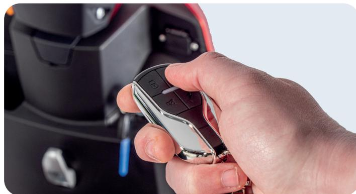
Offre un **telecomando Bluetooth** che permette di gestire comodamente lo scooter a distanza. Accendi e spegni lo scooter senza dover inserire la chiave nell'accensione, inoltre attiva e disattiva facilmente l'allarme del sistema antifurto.
