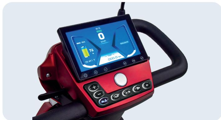
Una caratteristica notevole dello scooter Madagascar è il suo innovativo **touch screen da 7 pollici**, che fornisce all'utente informazioni di interesse sulle prestazioni dello scooter, come velocità, capacità della batteria e distanza percorsa
