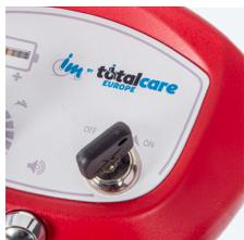
**!** Se si spegne l'alimentazione durante la guida, il freno elettromagnetico funzionerà e lo scooter si fermerà improvvisamente
