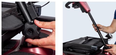
Sollevare il sedile nella posizione più alta. Una volta sollevato, si sentirà un "clic" che indica che il sedile è bloccato nella posizione estesa. Prima di sedersi, assicurarsi che il sedile sia fissato saldamente.
