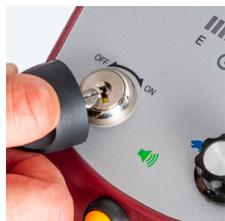
**⚠ Si se desconecta la alimentación durante la conducción, el freno electromagnético funcionará y el scooter se detendrá repentinamente**
