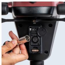
**Durante la ricarica l'interruttore della scatola batteria deve essere nello stato "ON", ovvero la ricarica viene eseguita quando è collegata l'alimentazione.**
