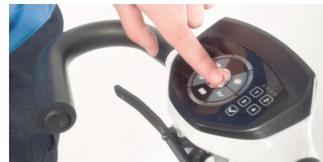
**Modalità sospensione:** lo scooter entrerà in modalità sospensione con un lungo segnale acustico di avviso se non viene rilevata alcuna attività della leva dell'acceleratore per un periodo di tempo programmabile. (Il tempo programmabile predefinito è 10 minuti.)
